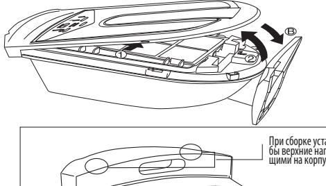
При сборке установите переднюю панель так, чтобы верхние направляющие совпали с направляющими на корпусе прибора.
