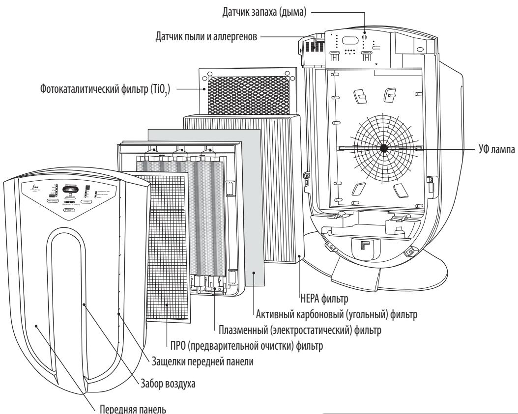
СХЕМА СИСТЕМЫ ФИЛЬТРАЦИИ
